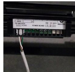
La pantalla se monta sobre el lado izquierdo del panel de acceso. Al retirar el panel de acceso, tenga cuidado de no desprender el cable de la pantalla.
