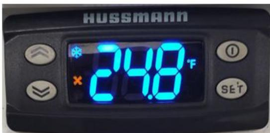
La temperatura de este gabinete puede reflejar el ciclo de refrigeración de la temperatura de referencia y su diferencial. La temperatura más precisa durante el funcionamiento de un gabinete se emplea para verificar la temperatura del producto.
