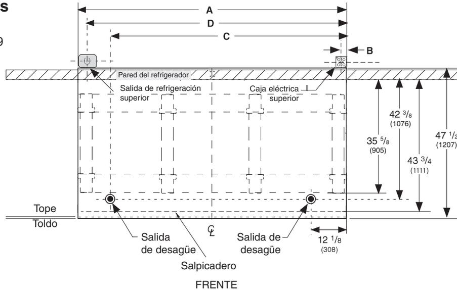
**Nota: TODOS LOS PUNTOS DE CONEXIÓN DEL CABLEADO EN EL LOCAL SE ENCUENTRAN ENCIMA DEL GABINETE. Las conexiones de un gabinete a otro se realizan en la caja eléctrica, en la parte superior del gabinete.**
