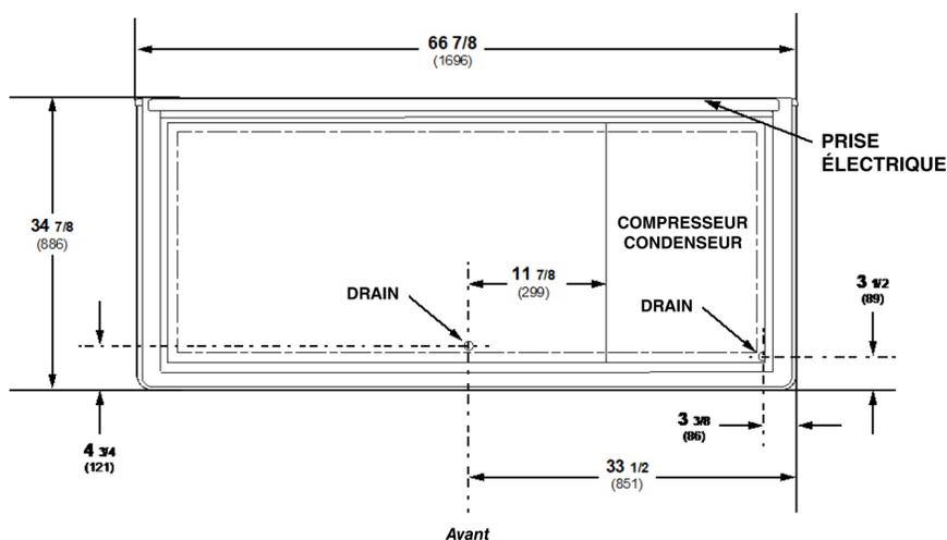
REMARQUE : Ce comptoir contient un bac d'évacuation et il ne requiert pas de drain de plancher.
