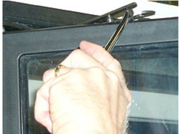
Soulever le dispositif de retenue de porte au-dessus de la vis à épaulement
