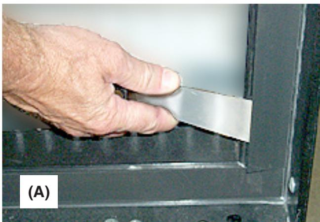
Comme il est indiqué à (B), utiliser un deuxième couteau à mastic ou un tournevis à lame plate pour maintenir le couvercle soulevé. Soulever le reste de la section avec le couteau à mastic seulement, jusqu'à ce que le couvercle entier soit retiré et que l'élément chauffant dans le cadre de porte soit exposé.
