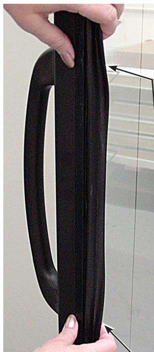
Éloigner soigneusement le joint magnétique du verre le plus près de la poignée pour exposer les vis de fixation, comme indiqué. Retirer les vis et remplacer la poignée. Une fois les vis posées, remettre soigneusement le joint en place. Au besoin, utiliser une solution d'eau et de savon doux pour lubrifier le joint. Nettoyer et sécher le joint pour terminer le remplacement de la poignée de porte.
