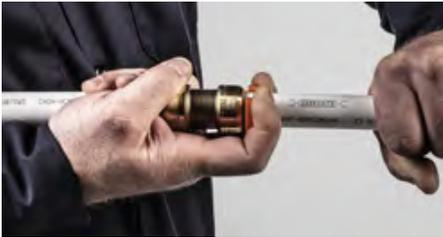
1. Coloque la abrazadera de desconexión SharkBite alrededor del tubo con la cara que no tiene la marca contra el collarín de liberación. Si usa las pinzas de desconexión SharkBite, coloque los dientes alrededor del conjunto del accesorio. El extremo de la horquilla con el logotipo de la marca SharkBite debe colocarse alrededor del tubo y el otro extremo alrededor del cuello del accesorio.
