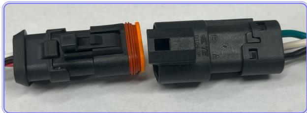
6. Teniendo cuidado de evitar la presencia de humedad en el exhibidor, conecte INMEDIATAMENTE y bloquee el nuevo arnés del motor de la siguiente manera:
