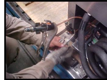
Cuando se asegure de que el orificio de salida no tenga fugas, suéldelo para cerrarlo. Retire todos los orificios de salida. Si utiliza una válvula Schrader en el tubo de salida del compresor, deberá retirarla y seguir los pasos anteriores para soldar el tubo para cerrarlo.
