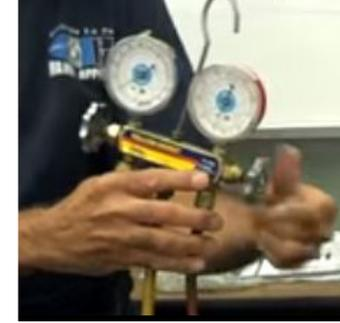
5. Con la válvula de succión en vacío, el refrigerante será recuperado en el tanque de recuperación.
