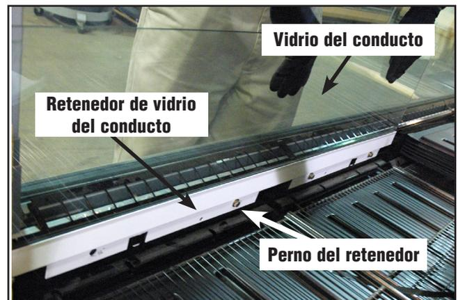
El vidrio del conducto está empacado dentro del exhibidor. Retire el embalaje y deslice el vidrio del conducto de forma segura en el labio superior del retenedor del vidrio del conducto. Sujete (4) pernos en los retenedores de tuercas (7 lbf). NO apriete los pernos en exceso.
