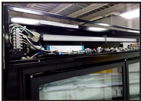
Lámpara LED y fuente de alimentación mostradas sin el panel de la pantalla
