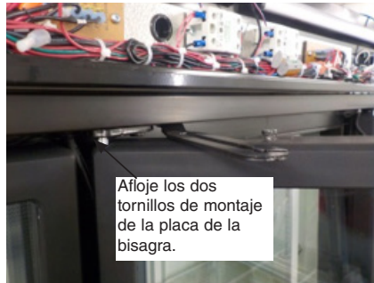
Ajuste de la combadura de las puertas
