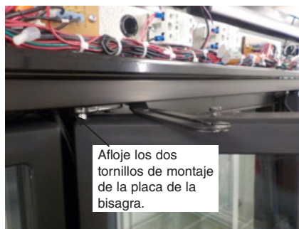
Ajuste de la combadura de las puertas
