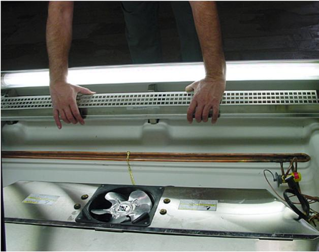
**PASO 12 – Gire el pleno del ventilador hacia arriba y hacia atrás; enganche la cadena en la parte trasera del recubrimiento.**
