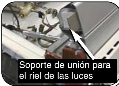
**Figura 2.** Revisión del perno de alineación y del soporte para unir el riel de las luces
