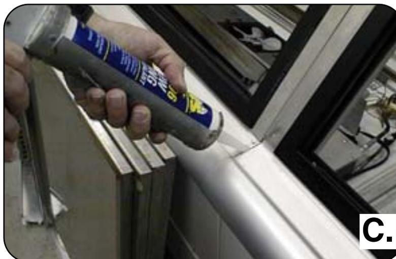
Figura 16. Sellado de juntas de las cajas
