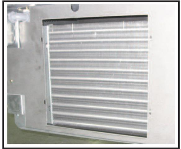
El bloqueo del flujo de aire aumenta el consumo de energía y reduce la capacidad del exhibidor para mantener la temperatura de operación.
