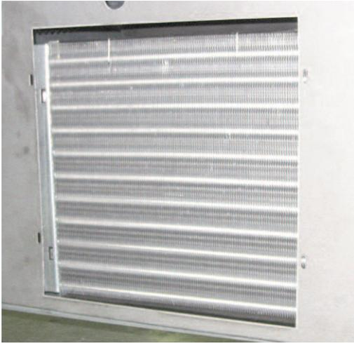
El bloqueo del flujo de aire aumenta el consumo de energía y reduce la capacidad del exhibidor de mantener la temperatura de operación.
