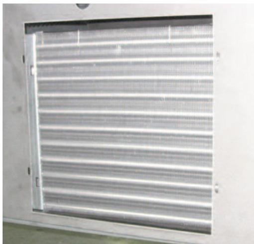
Le blocage du flux d'air augmente la consommation d'énergie et réduit la capacité du présentoir à conserver la température de fonctionnement.
