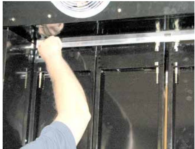
Ajuste la puerta horizontalmente
