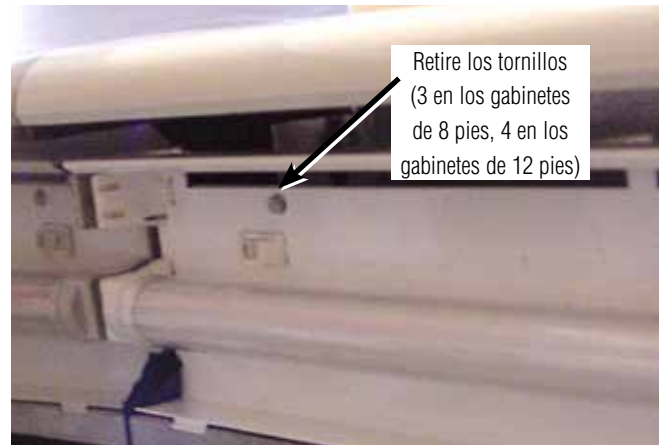
Retire el ensamble de la lámpara frontal para acceder a los tornillos
