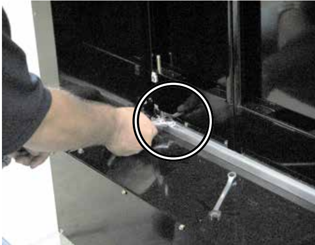
Ajuste la puerta horizontalmente
