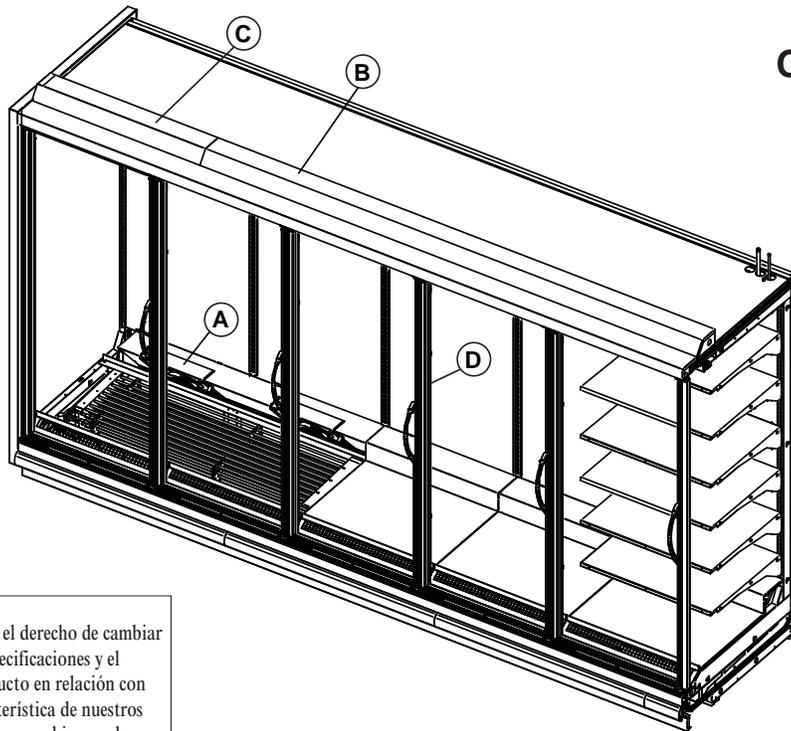
Las conexiones eléctricas y de refrigeración se encuentran en la parte superior. Se requieren circuitos eléctricos y tuberías elevadas.
