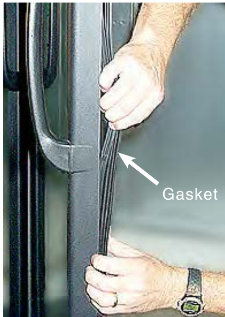
Remove Door Gasket
