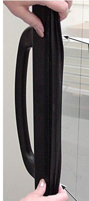
Desprenda con cuidado el sello magnético del vidrio más cercano a la manija, para exponer los tornillos de montaje como se muestra. Retire los tornillos y reemplace la manija. Después de instalar los tornillos, empuje con cuidado el sello de regreso a su lugar. De ser necesario, use una solución de jabón suave y agua para lubricar el sello. Limpie y seque el sello para completar el reemplazo de la manija de la puerta.
