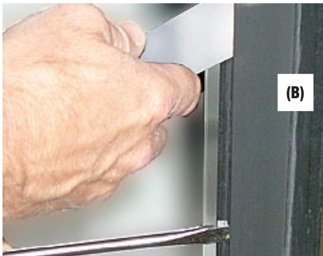
**Retire la cubierta del paso de cables**
