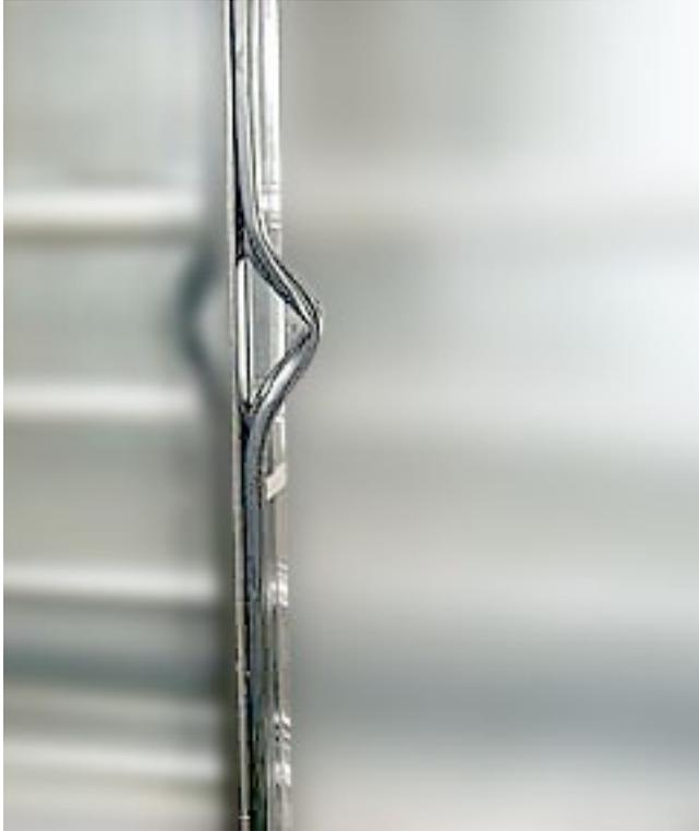
**Sello dañado o mal instalado**
