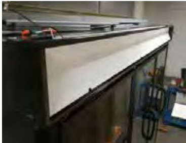
L'afficheur se glisse pour donner accès au chemin de câbles.
