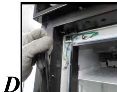
Une fois les couvercles remis en place, rétablir l'alimentation et vérifier que les éléments chauffants fonctionnent correctement.
