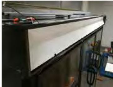
4. Retirer le couvercle afin d'accéder à l'éclairage DEL et au bloc d'alimentation DEL.
