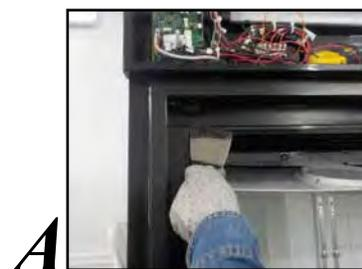
Utiliser un deuxième couteau à mastic ou un tournevis à lame plate pour maintenir le couvercle soulevé, comme indiqué en **A**. Soulever le reste de la section avec le couteau à mastic seulement, jusqu'à ce que le couvercle entier soit retiré et que l'élément chauffant dans le cadre de porte soit exposé, comme indiqué en **B**.
