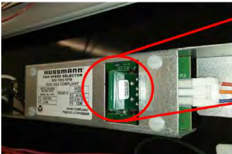
Selector de velocidad de los ventiladores
