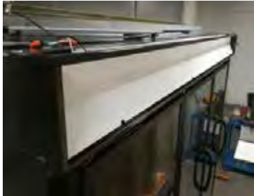
La pantalla se desliza hacia fuera para tener acceso al paso de cables
