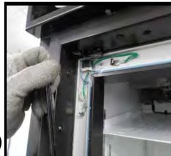
Después de reinstalar las cubiertas, reconecte la energía eléctrica y verifique que los calentadores funcionen adecuadamente.
