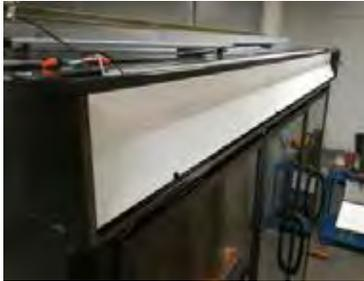
4. Retire la cubierta de la pantalla para tener acceso a la lámpara LED y a su fuente de alimentación.
