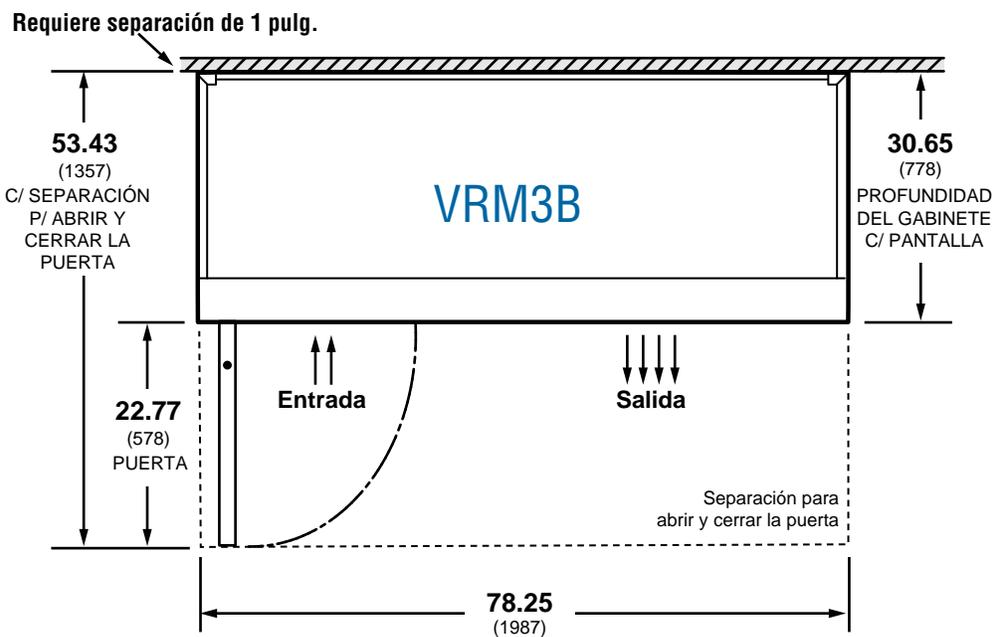
Las dimensiones del corte transversal de VRM se muestran en pulg. y (mm).
