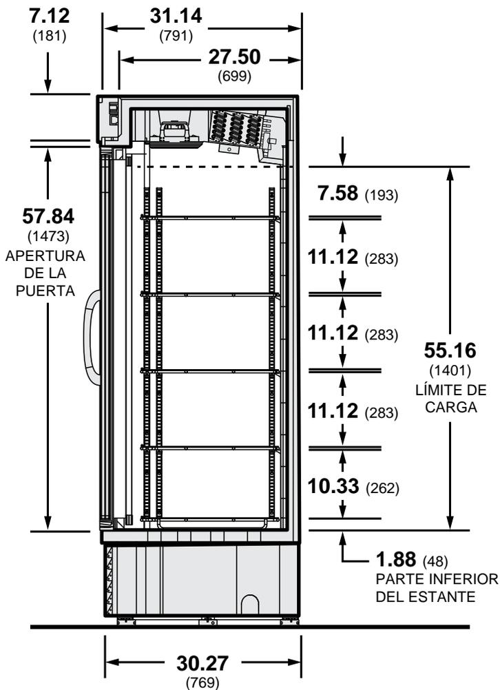
Las dimensiones del corte transversal de VRM se muestran en pulg. y (mm).
