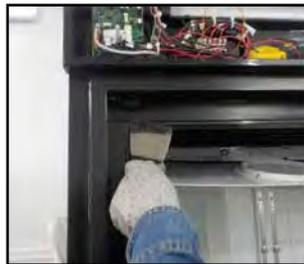
Use una segunda navaja para masilla o un destornillador plano para sostener la cubierta, como se muestra en **A**. Haga palanca hacia arriba en el resto de la sección usando solo la navaja para masilla, hasta que toda la cubierta se desprenda y quede expuesto el calentador dentro del marco de la puerta, como se muestra en **B**.
