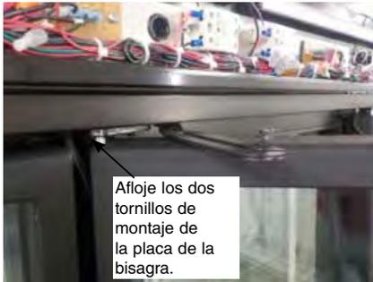
Afloje los dos tornillos de montaje de la placa de la bisagra.
