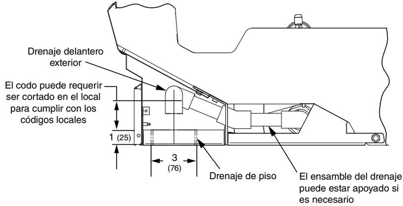
**IMPORTANTE:** Si se usa un centro de drenaje en vez de un fregadero al ras con el piso, se debe de instalar un kit de extensión de drenaje. Los centros de drenaje se deben ubicar en frente de la salida de desagüe para lograr una separación de aire adecuada.
