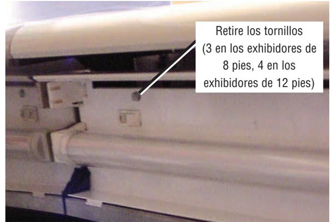
**Retire el ensamble de la lámpara delantera para acceder a los tornillos**
