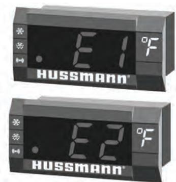
Si el LED de alarma de temperatura o sensor (rojo) del controlador y la pantalla está parpadeando, es que falló un sensor de temperatura. La pantalla muestra E2 si ha fallado el sensor del evaporador.
