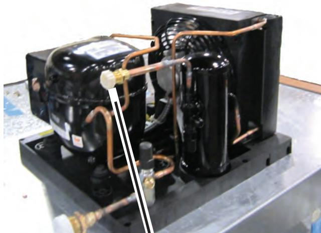
Conexión rápida de salida
