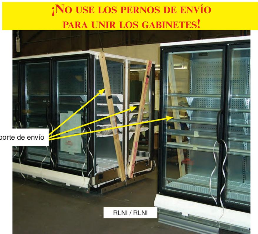
Figura 3. Retire los soportes de envío
