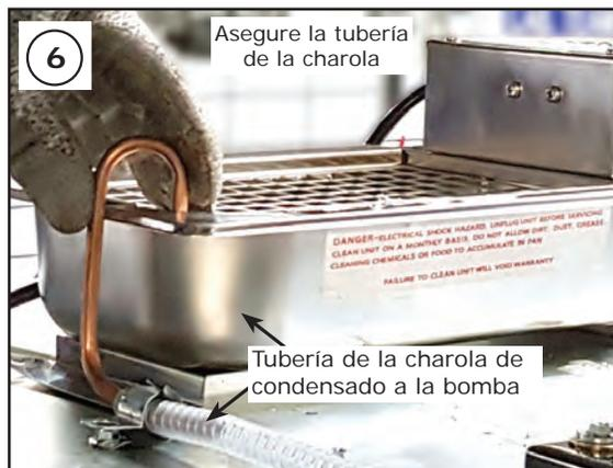
Asegure la tubería
