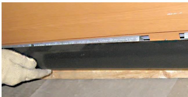
4. Retire los tornillos que conecten la charola del paso de cables al ensamblaje inferior.
