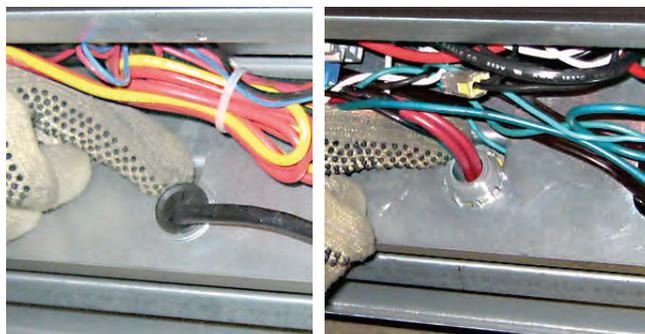
6. Retire los tornillos que sujetan la argolla de tierra a la charola del paso de cables.
