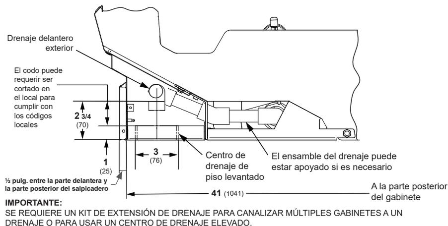
**IMPORTANTE:** Si se usa un centro de drenaje en vez de un fregadero al ras con el piso, se debe de instalar un kit de extensión de drenaje. Los centros de drenaje se deben ubicar en frente de la salida de desagüe para lograr una separación de aire requerida.
