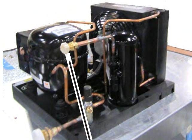
Conexión rápida de salida
