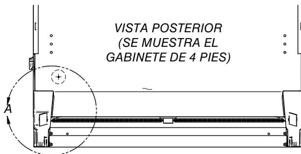
La tubería de interconexión dentro del gabinete debe ubicarse tal como se muestra abajo a fin de dejar espacio para levantar los plenos articulados de los ventiladores y dejar espacio por debajo de las charolas de exhibición. Como alternativa, la tubería de interconexión puede colocarse por fuera del gabinete.
