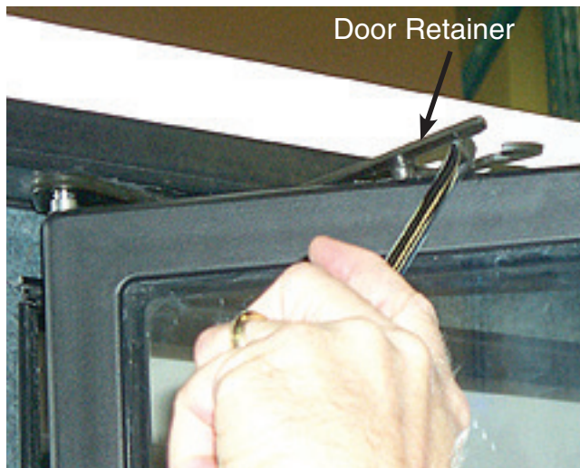
Lift Door Retainer
