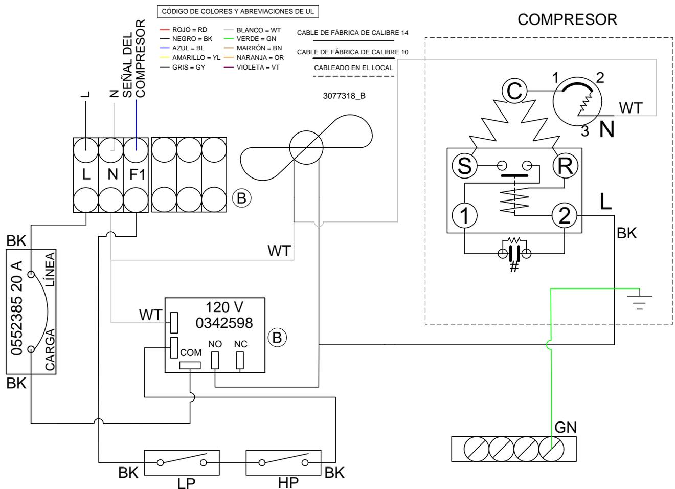
DIAGRAMA DE CABLEADO-UNIDAD CONDENSADORA DE TEMPERATURA MEDIA
