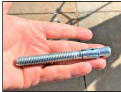
Figura 1-6a Anclaje de cuña para concreto
