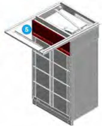
6. Retire la caja de conexiones eléctricas.
