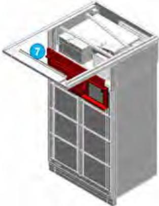
8. Retire los soportes de sujeción del protector superior.
