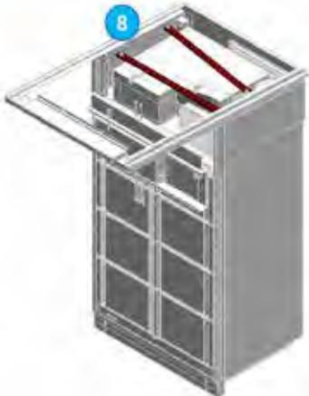
9. Retire la cubierta delantera del protector superior.
