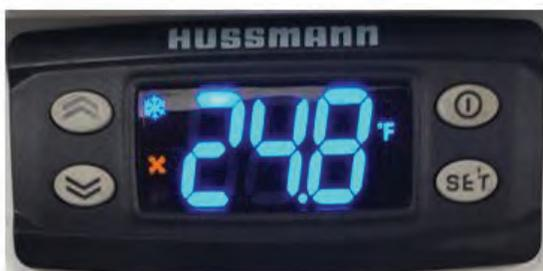
La temperatura del gabinete puede reflejar el ciclo de refrigeración de la temperatura de referencia y su diferencial. La temperatura más precisa durante el funcionamiento de un gabinete se emplea para verificar la temperatura del producto.
