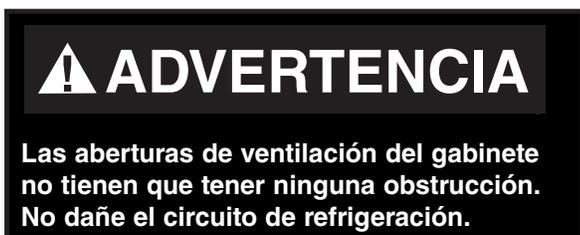
Deje una separación mínima de 10 pulg. de las paredes, exhibidores y cualquier otro objeto grande que esté cerca de los paneles con base ventilada del exhibidor (para los modelos autocontenidos). Si se bloquea o restringe el flujo de aire, se afectará negativamente el rendimiento y se podría dañar el sistema de refrigeración.
