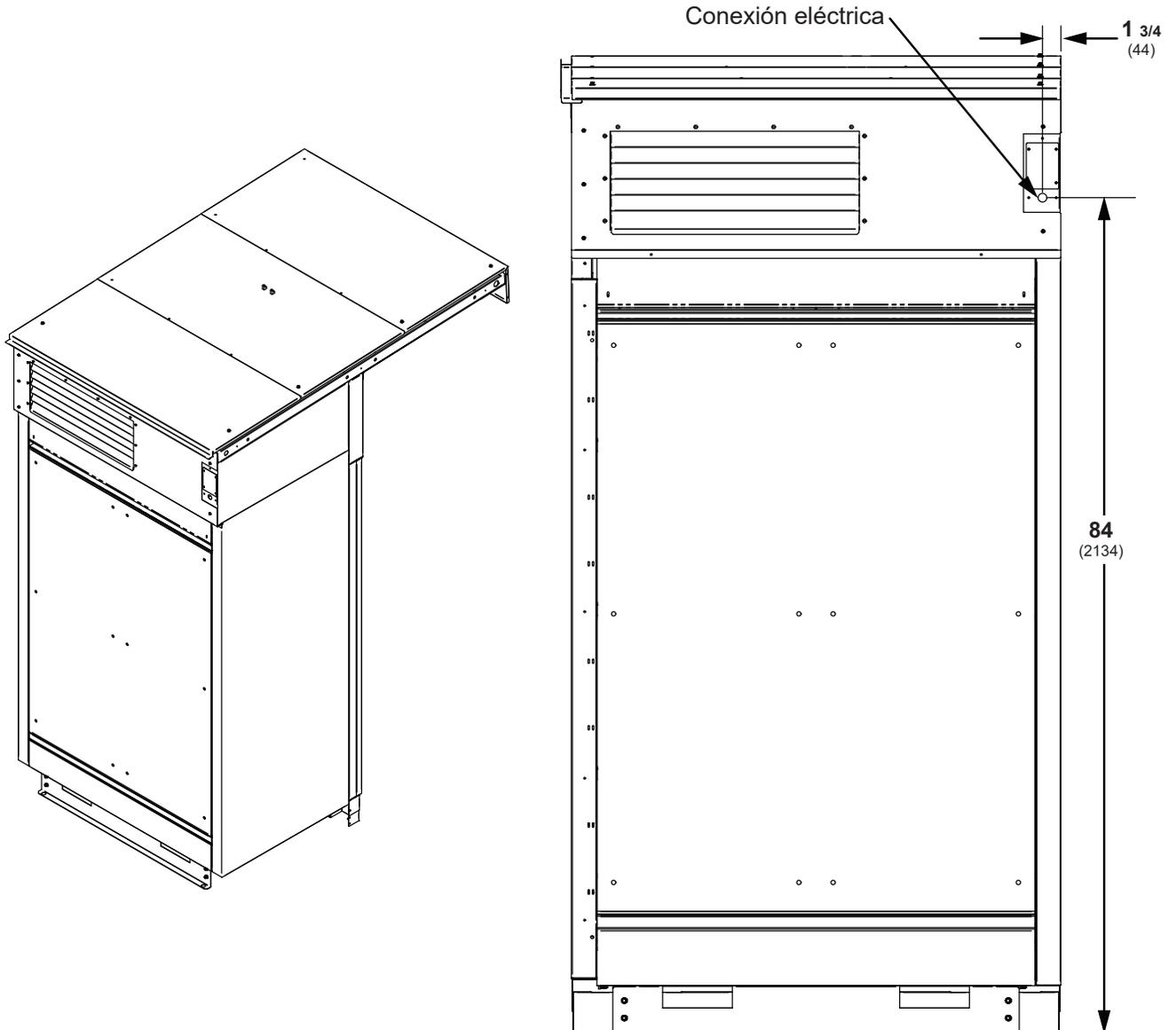
*Parte posterior del módulo (dimensiones a la parte posterior de la caja de conexiones)*
