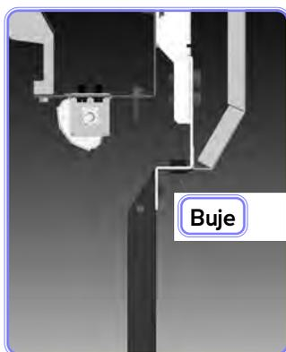
8. Instale el ensamble de la placa inferior en el riel de soporte. El ensamble de la placa inferior está marcado con una "L" (izquierda) o una "R" (derecha). La referencia es parándose de frente al gabinete. Repita para las otras aberturas.
